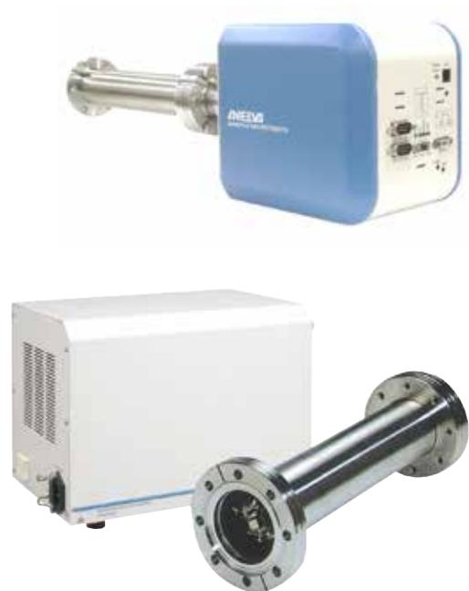
高感度分析、低ガス放出の要求に応える四重極型質量分析計
