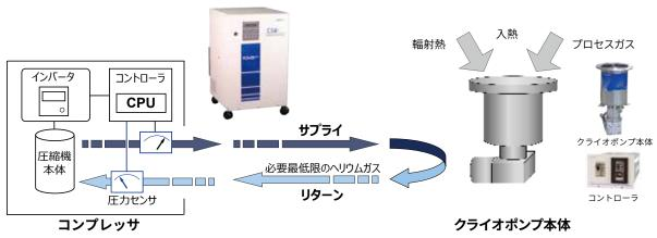
サプライとリターン側の圧力差が一定になるように 圧縮機本体の回転数を制御します。 クライオポンプで消費された分のみのヘリウムガス を圧縮し供給します。 クライオポンプの温度が一定になるように冷凍機の 出力(運転速度)を調節して運転します。 クライオポンプへの熱負荷量に相当するヘリウムガス量 を消費します。
