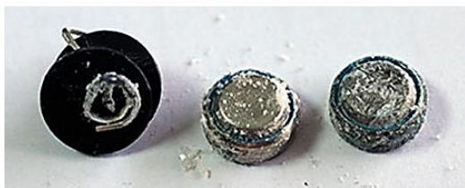
— 長期使用による液漏れ —
