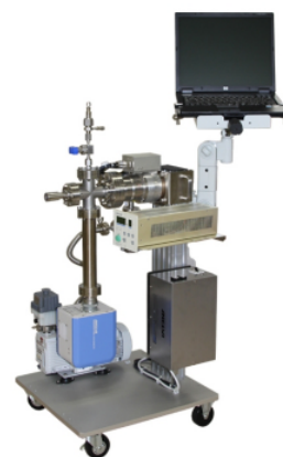
真空計、およびノートPC 設置例
