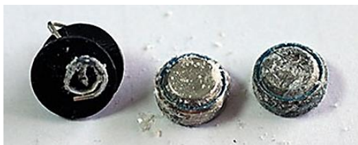
— 長期使用による液漏れ —
