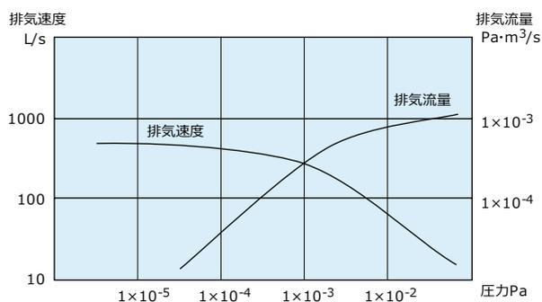
第2図 排気速度・排気流量—圧力特性
