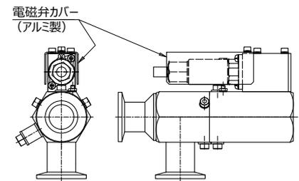
連続通電により電磁弁が高温になります。
