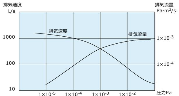
第4図 排気速度・排気流量-圧力特性
