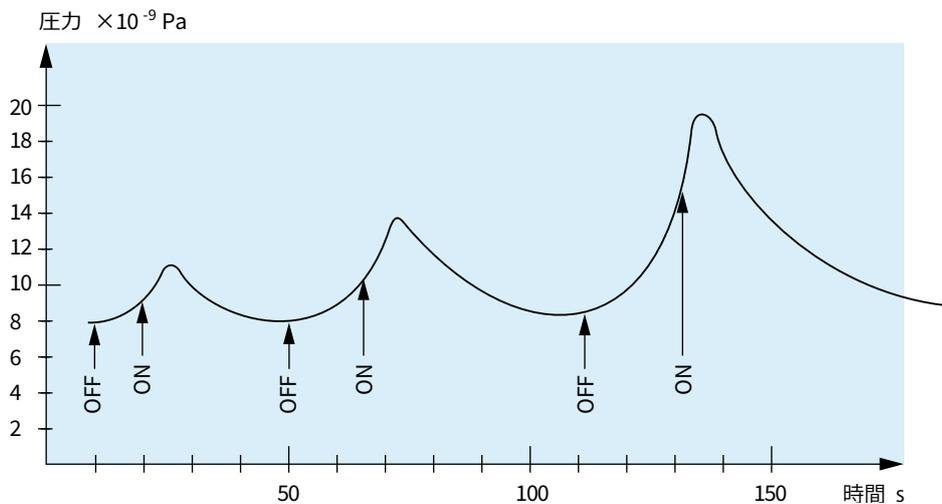
第3図  $10^{-9}$  Pa でイオンポンプを ON-OFF した時の圧力変化
