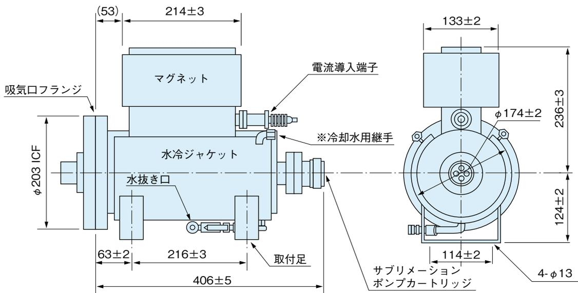
※この継手は、外径 8 mm の SUS パイプ（光輝焼鈍したオーステナイトステンレス鋼）または、銅パイプ用です。
