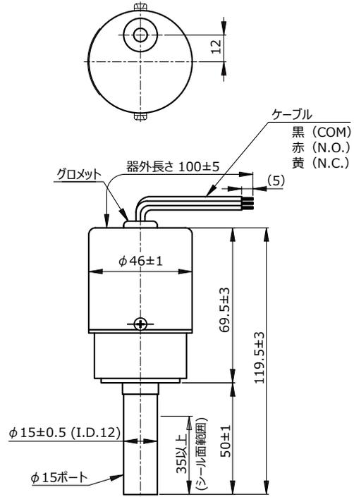
図2 V-070VS-Tの外形寸法図
