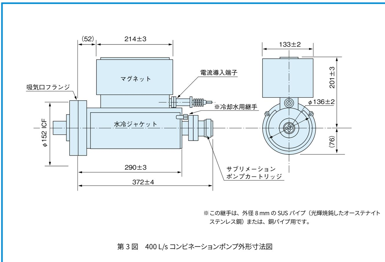
第3図 400 L/s コンビネーションポンプ外形寸法図
