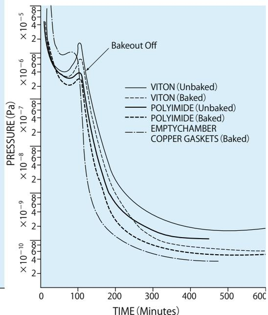
第 2 図 シール材の比較 (到達圧力)
