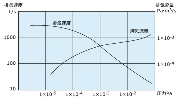
第 6 図 排気速度・排気流量—圧力特性
