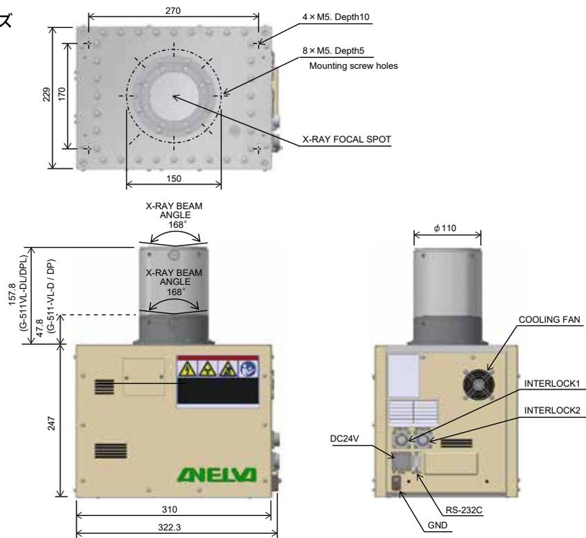
設置面：上面(照射口側)と底面
