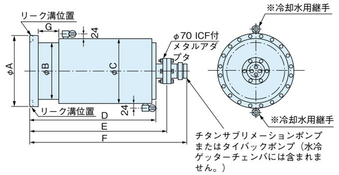
※この継手は、外径 8 mm の SUS パイプ（光輝焼鈍したオーステナイトステンレス鋼）または、銅パイプ用です。
